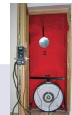
Blower door test
